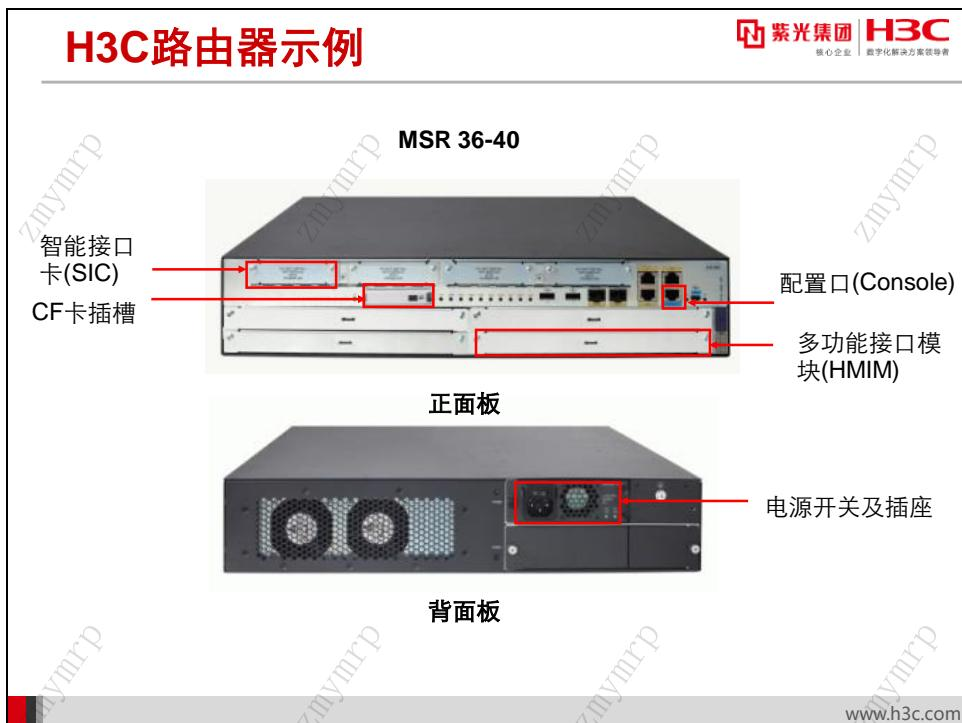
上图显示了 H3C MSR36-40 路由器的直观图。MSR36-40 是一种模块化的路由器，前面板主要包括配置口 (Console) 和 CF 卡插槽以及多种类型的接口模块插槽。前面板还配置了系统指示灯、接口指示灯、CF 卡指示灯，以辅助用户对系统运行状态进行监控和判断。
