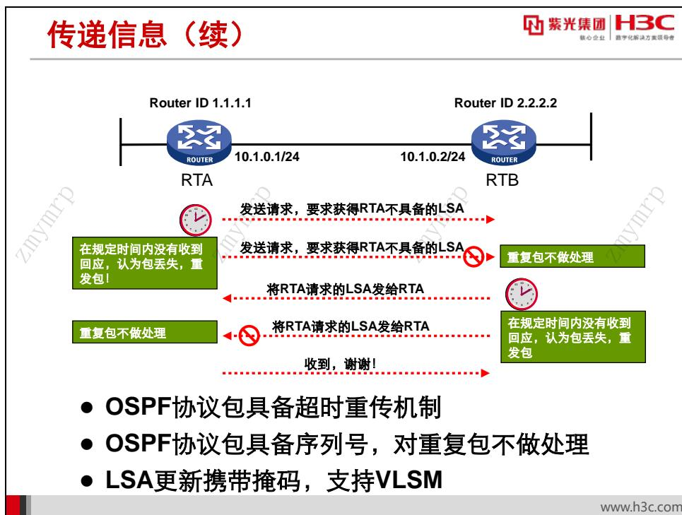
OSPF 协议具备超时重传机制。在 LSA 更新阶段，如果发送的包在规定时间内没有收到对方的回应，则认为包丢失，重新发送包。
