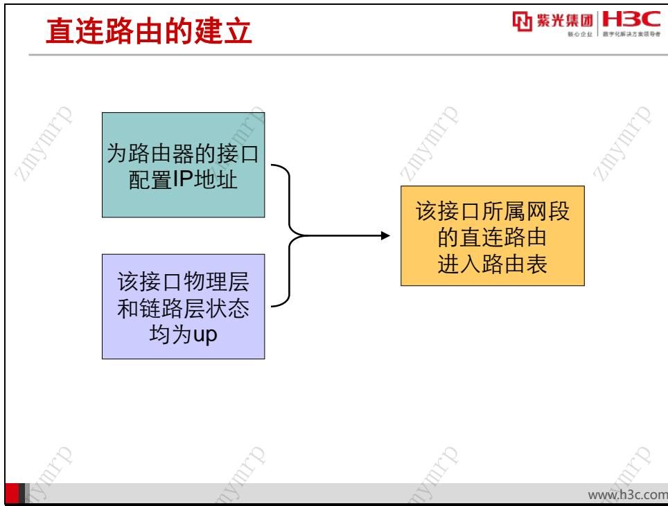
直连路由是指路由器接口直接相连的网段的路由。直连路由不需要特别的配置，只需在路由器的接口上配置 IP 地址即可。但路由器会根据接口的状态决定是否使用此路由。如果接口的物理层和链路层状态均为 **up**，路由器即认为接口工作正常，该接口所属网段的路由即可生效并以直连路由出现在路由表中；如果接口状态为 **down**，路由器认为接口工作不正常，不能通过该接口到达其地址所属网段，也就不能以直连路由出现在路由表中。
