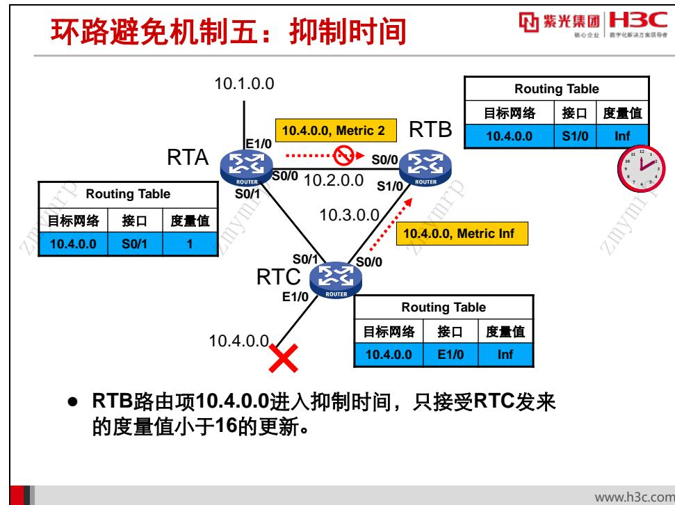
抑制时间与路由毒化结合使用，能够在一定程度上避免路由环路产生。抑制时间规定，当一条路由的度量值变为无穷大（16）时，该路由将进入抑制状态。在被抑制状态，只有来自同一邻居且度量值小于无穷大（16）的路由更新才会被路由器接收，取代不可达路由。
