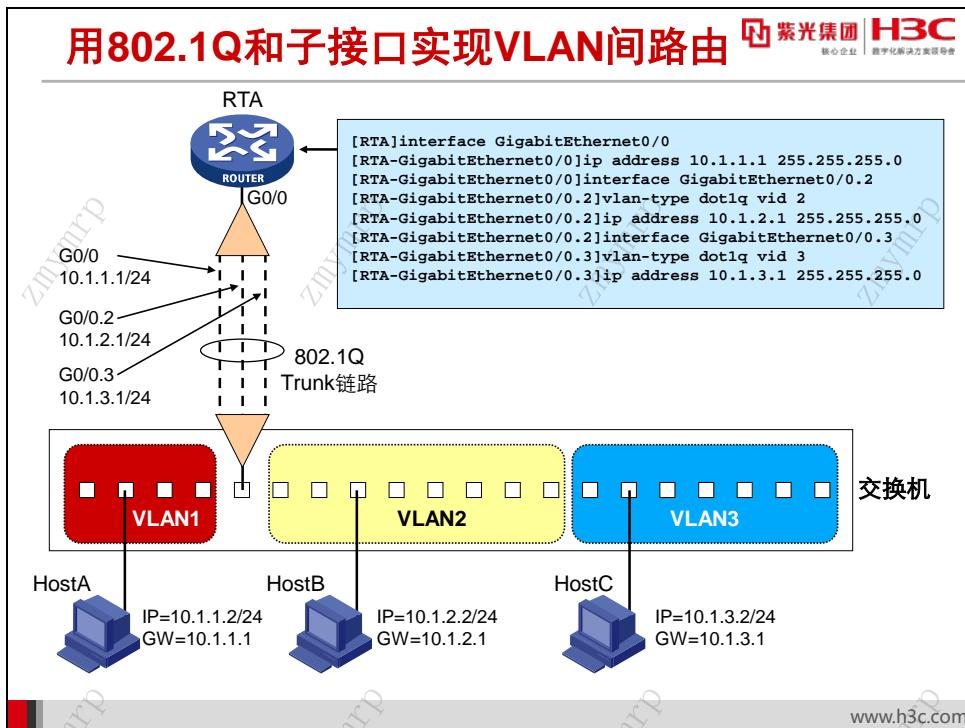
为了避免物理端口和线缆的浪费，简化连接方式，可以使用 802.1Q 封装和子接口，通过一条物理链路实现 VLAN 间路由。这种方式也被形象地称为“单臂路由”。
