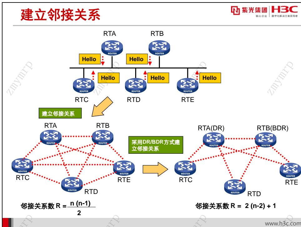
可以将邻接关系比喻为一条点到点的虚连接，那么可以想象，在广播型网络的 OSPF 路由器之间的邻接关系是很复杂的。假设 OSPF 区域内有 5 台路由器，它们彼此互为邻居并都建立邻接关系，那么总共会有 10 个邻接关系；如果是 10 台路由器，那么就有 45 个邻接关系；如果有  $n$  台路由器，那么就有  $n(n-1)/2$  个邻接关系。邻接关系需要消耗较多的资源来维持，而且邻接路由器之间要两两交互链路状态信息，这也会造成网络资源和路由器处理能力的巨大浪费。
