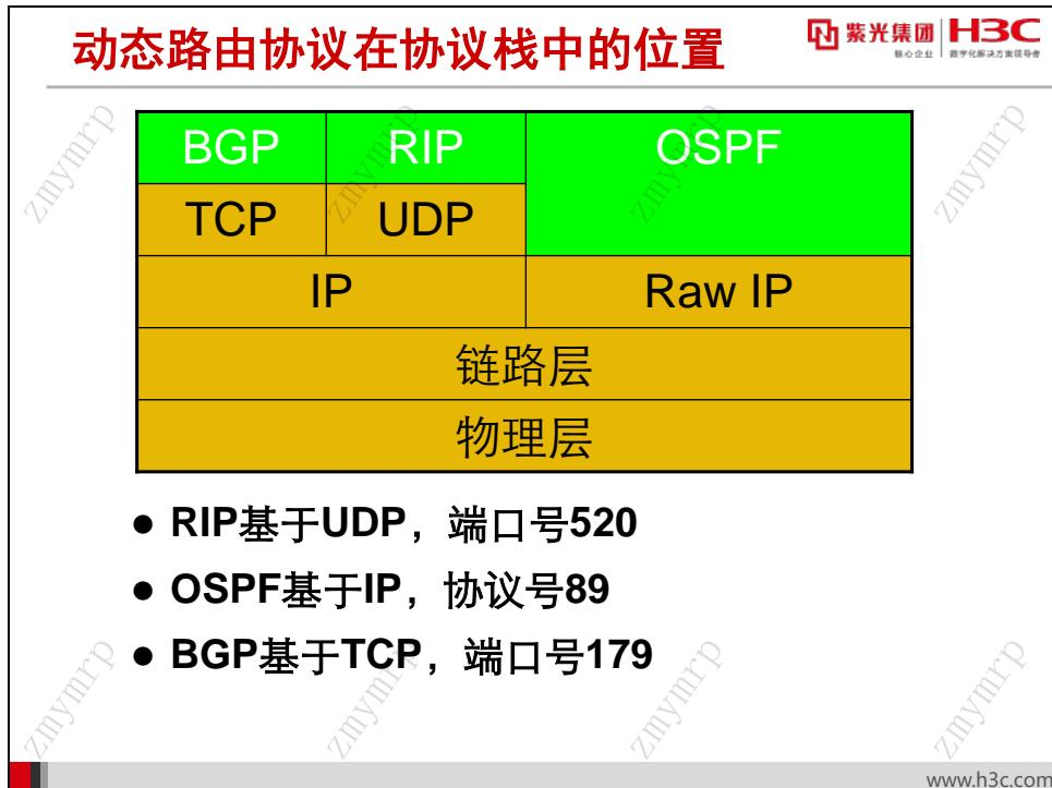
各种路由协议使用的底层协议各有不同。
