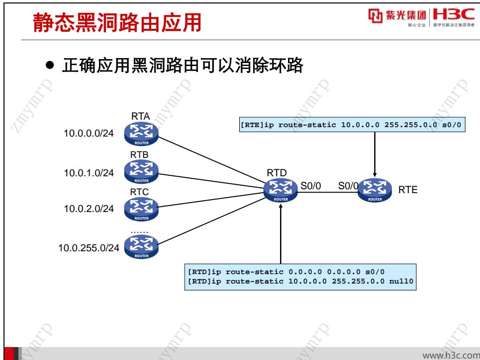
在配置静态路由时，对应接口可以配置为 NULL0。NULL 接口是一个特别的接口，我们无法在 NULL 接口上配置 IP 地址，路由器会提示配置非法。一个没有 IP 地址的接口能够做什么用呢？此接口单独使用没有意义，但是在一些网络中正确使用能够避免路由环路。
