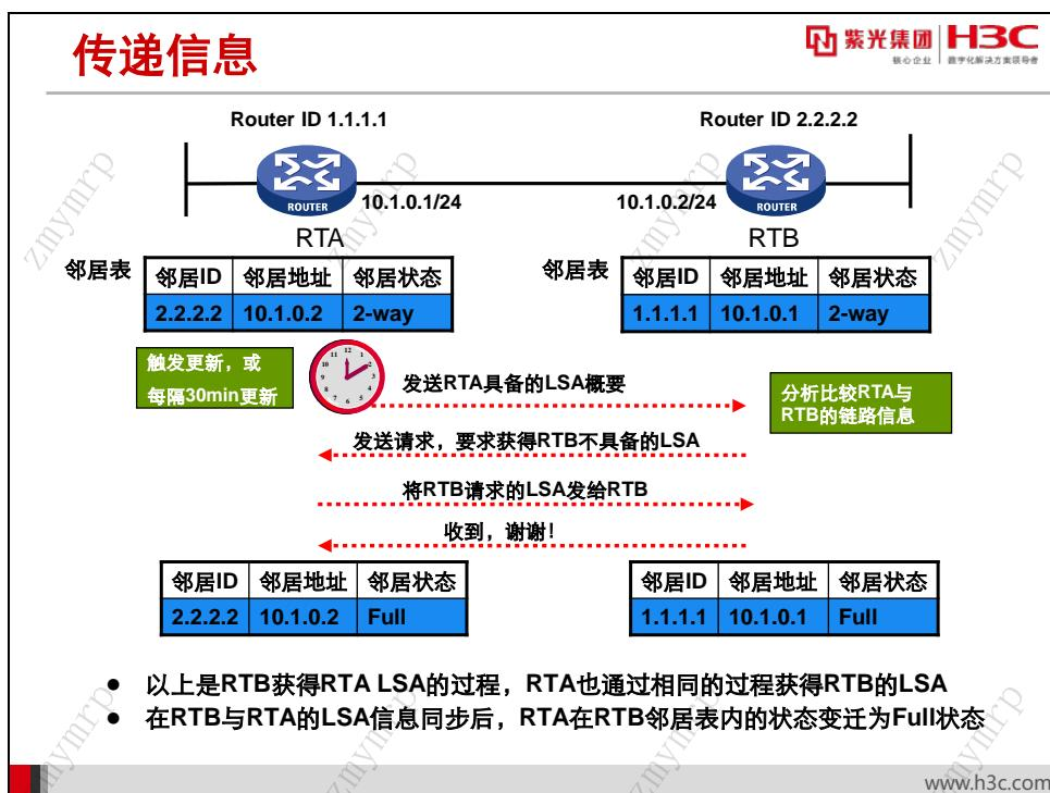
建立邻接关系的 OSPF 路由器之间通过发布 LSA (Link State Advertisement, 链路状态公告) 来交互链路状态信息。通过获得对方的 LSA，同步 OSPF 区域内的链路状态信息后，各路由器将形成相同的 LSDB (Link State DataBase, 链路状态数据库)。
