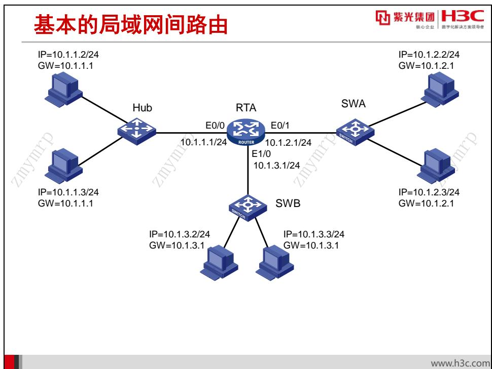
基本的局域网间路由如图所示。其中路由器 RTA 的三个以太口分别连接三个局域网段，只需在 RTA 上为其三个以太口配置 IP 地址，即可为 10.1.1.0/24、10.1.2.0/24 和 10.1.3.0/24 网段提供路由服务。
