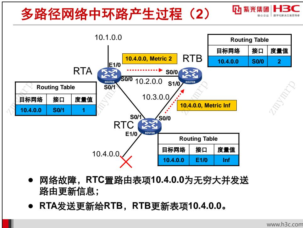
RTC 的接口产生故障后，RTC 会向邻居路由器 RTB 和 RTA 发送更新消息，告知 RTA 和 RTB 网络 10.4.0.0 经由 RTC 不再可达。但是，假设 RTB 已经收到 RTC 的更新，而在 RTC 的这个更新到达 RTA 之前，RTA 的更新周期恰巧到来，RTA 会向 RTB 发送路由更新，其中含有路由项 10.4.0.0，跳数为 2。RTB 收到 RTC 的路由更新后已经删除了 10.4.0.0 网段的路由，所以会以此路由更新为准，向自己的路由表中加入路由项 10.4.0.0，下一跳指向 RTA，跳数为 2。
