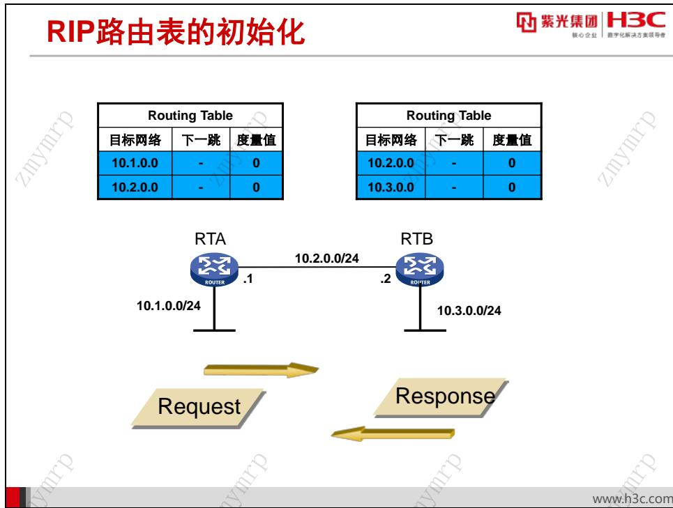
未启动 RIP 的初始状态下，路由表中仅包含本路由器的一些直连路由。RIP 启动后，为了尽快从邻居获得 RIP 路由信息，RIP 协议使用广播方式向各接口发送请求报文（Request message），其目的是向 RIP 邻居请求路由信息。
