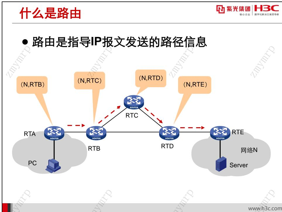
路由器提供了将异构网互联的机制，实现将一个数据包从一个网络发送到另一个网络。路由就是指导 IP 数据包发送的路径信息。
