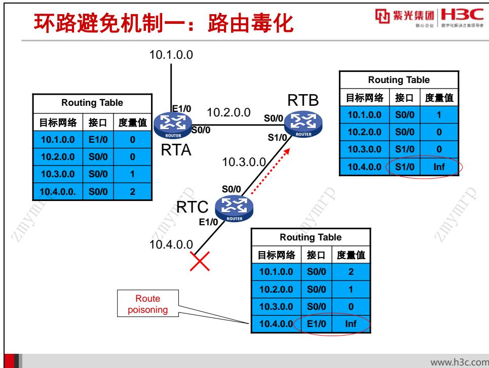
在前面路由环路生成的例子中，当网络 10.4.0.0 发生故障时，RTC 把路由项 10.4.0.0 从路由表中删除，以至于 RTB 不知道网络 10.4.0.0 发生故障。所谓路由毒化（Route Poisoning）就是路由器主动把路由表中发生故障的路由项以度量值无穷大（16）的形式通告给 RIP 邻居，以使邻居能够及时得知网络发生故障。
