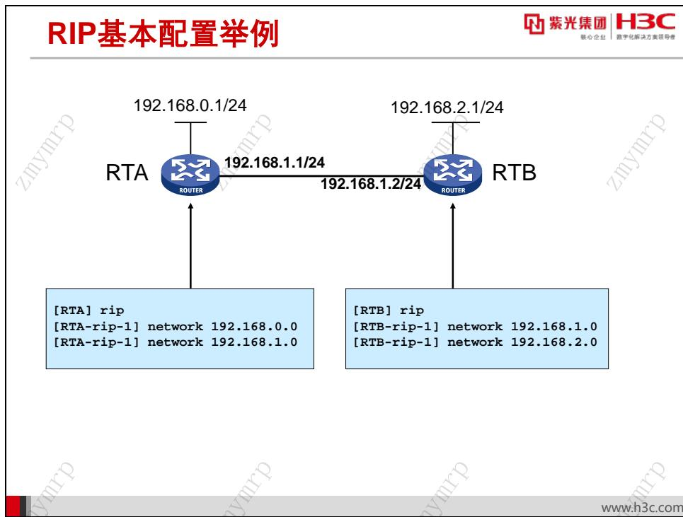
上图是 RIP 的基本配置示例。图中所有的网络使用自然掩码，没有子网划分，所以可以使用 RIPv1。在两台路由器所有的接口上使能 RIP。
