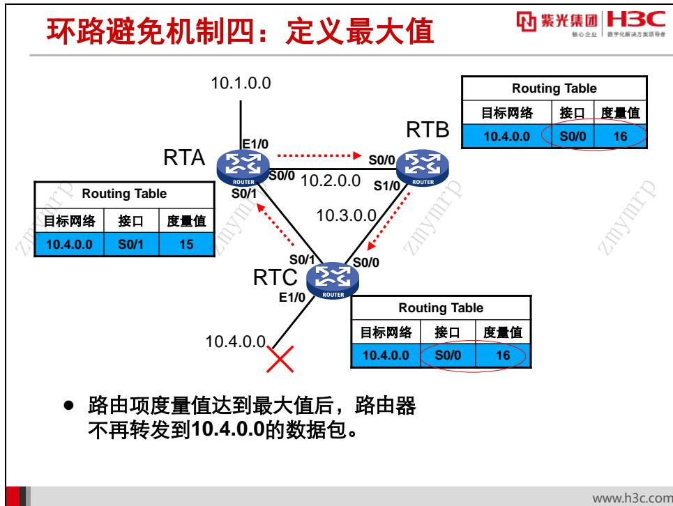
为解决上述问题，我们给每种距离矢量路由协议度量值定义一个最大值。在 RIP 路由协议中，规定度量值是跳数，所能达到的最大值为 16。其实，在前面的例子中，我们已经使用跳数 16 来表示度量值的最大值了。
