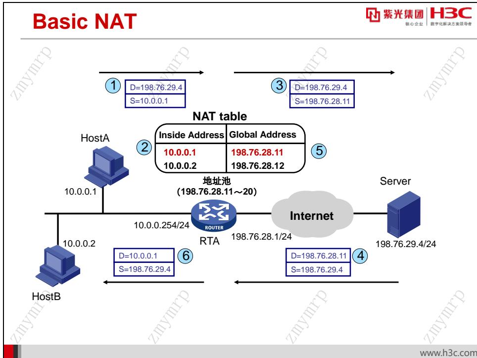
Basic NAT 是最简单的一种地址转换方式，只对数据包的 IP 层参数进行转换。
