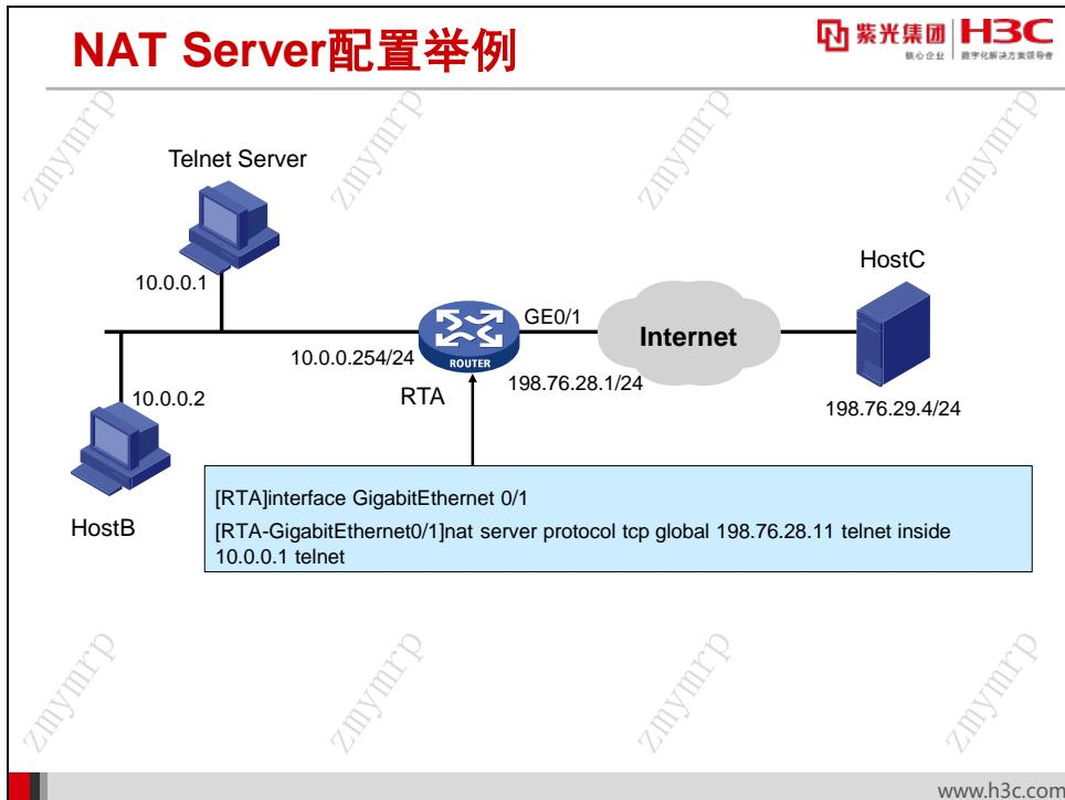
在本例中，HostA 是一台 Telnet Server，私网地址为 10.0.0.1，由端口 23 提供 Telnet 服务，在 RTA 上为 HostA 静态映射公网地址 198.76.28.11 和协议端口。配置如下即可：
