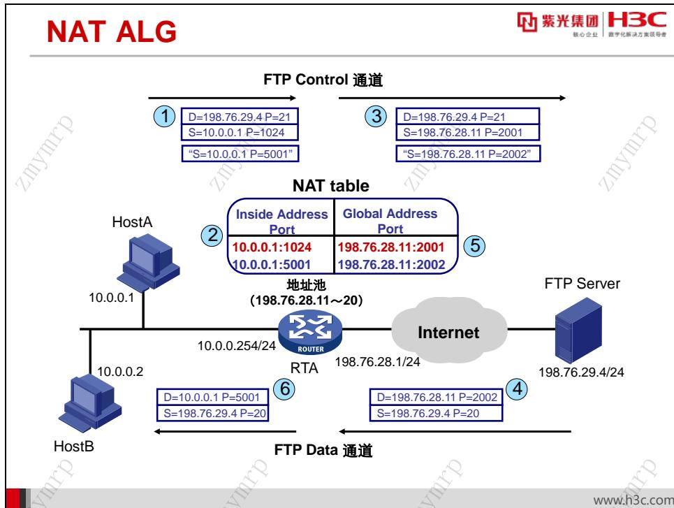
传统 NAT (Basic NAT 和 NAPT) 只能识别并修改 IP 报文中的 IP 地址和 TU Port 信息，不能修改报文内部携带的信息，因此对于一些在 IP 报文载荷 (Payload) 中内嵌网络底层信息 (IP 地址或 TU 端口等) 的协议——例如 FTP、H.323、SIP 等，是无法正确转换的。
