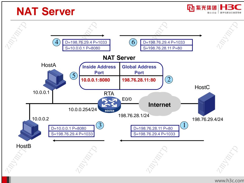
从 Basic NAT 和 NAPT 的工作原理可见, NAT 表项由私网主机主动向公网主机发起访问而触发建立, 公网主机无法主动向私网主机发起连接。因此 NAT 隐藏了内部网络的结构, 具有屏蔽内部主机的作用。但是在实际应用中, 在使用 NAT 的同时, 内部网络可能需要对外提供服务, 例如 Web 服务、FTP 服务等, 常规的 NAT 就无法满足要求了。
