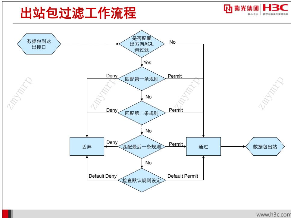
ACL 包过滤具有方向性，可以指定对出或入接口方向的数据包过滤。
