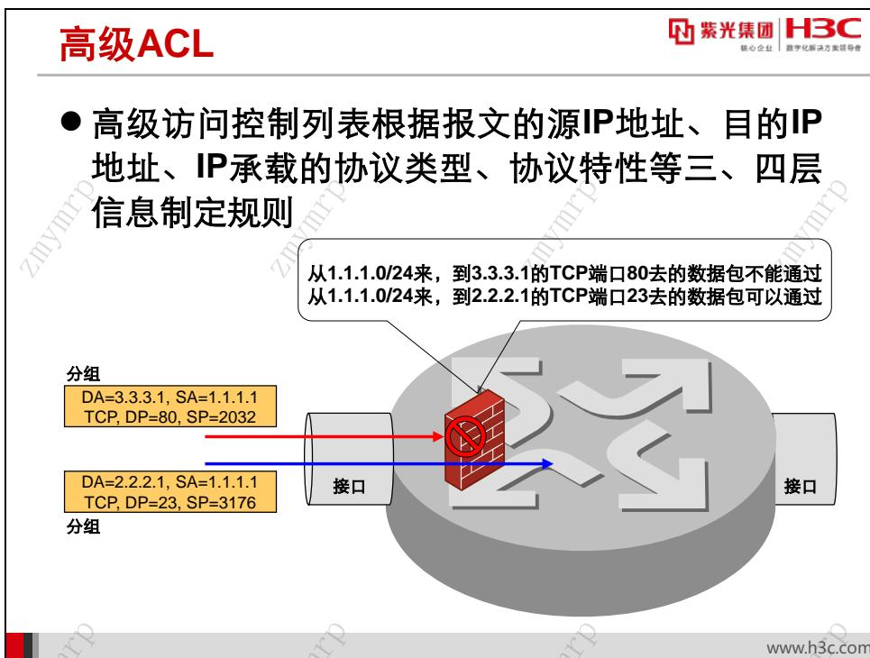
因为高级访问控制列表根据报文的源 IP 地址信息、目的 IP 地址信息、IP 承载的协议类型、协议的特性等三、四层信息制定规则，所以比较适合于过滤某些网络中的应用及过滤精确的数据流的情形。
