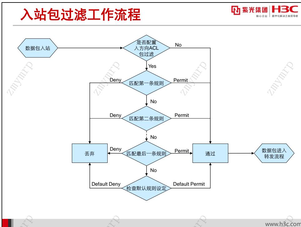
包过滤防火墙的规则设定通过引用 ACL 来实现。一个 ACL 可以包含多条规则（rule），每条规则都定义了一个匹配条件及其相应动作。
