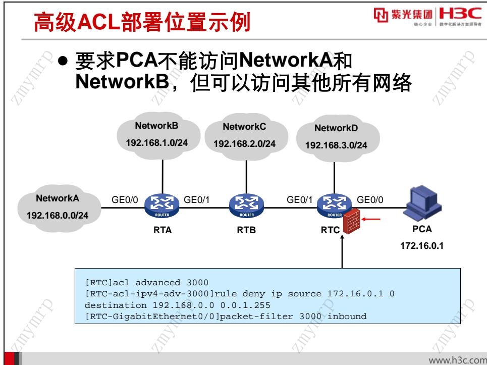
在上图中，用户想要实施 ACL 包过滤来阻断从主机 PCA 到 NetworkA 和 NetworkB 的数据包。如果用高级 ACL 来实现，在任意一台路由器上实施 ACL 都可以达到目的。但最好的实施位置是在路由器 RTC 的 G0/0 接口上，因为可以最大程度地减少不必要的流量处理与转发。
