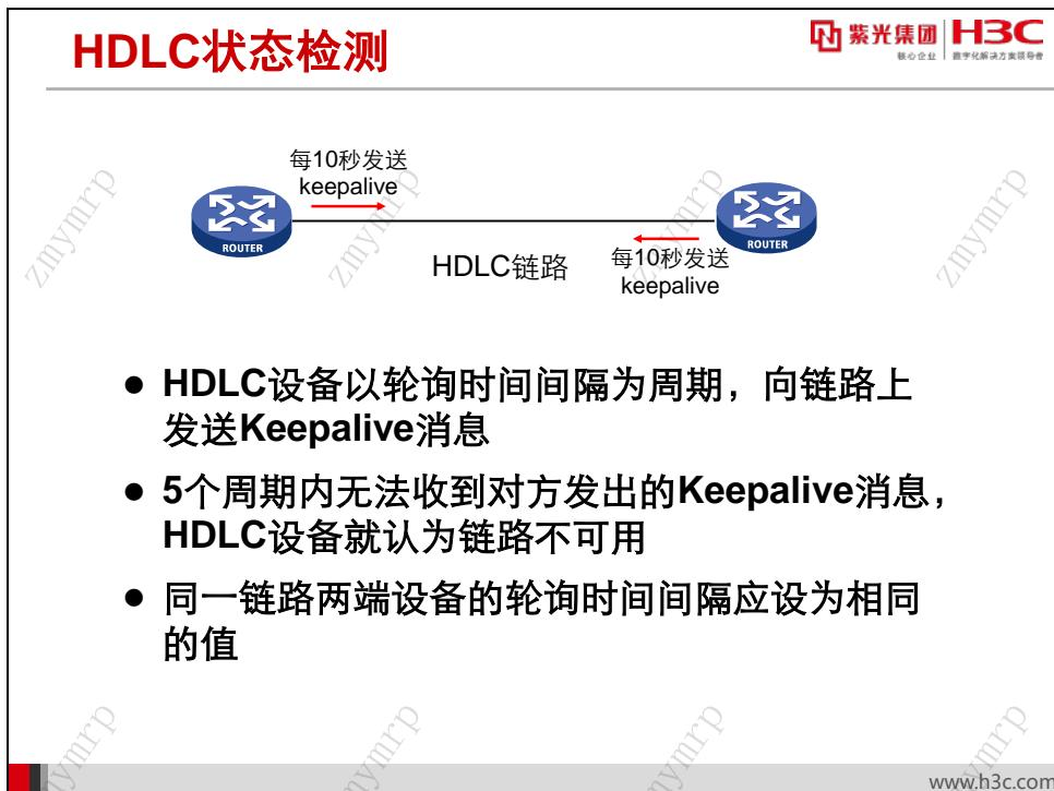
HDLC 具有简单的探测链路及对端状态的功能。在链路物理层就绪后，HDLC 设备以轮询时间间隔为周期，向链路上发送 **Keepalive** 消息，探测对方设备是否存在。如果在 5 个周期内无法收到对方发出的 **Keepalive** 消息，HDLC 设备就认为链路不可用，则链路层状态变为 **Down**。
