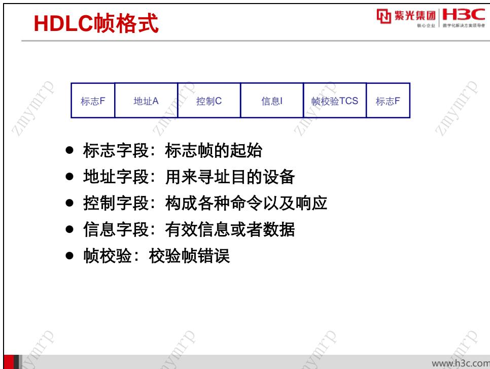
在 HDLC 中，数据和控制报文均以帧的标准格式传送。总体上，HDLC 有三种不同类型的帧：信息帧（I 帧）、监控帧（S 帧）和无编号帧（U 帧），这三种类型不同的 HDLC 帧在 HDLC 协议中发挥着不同的作用。其中：
