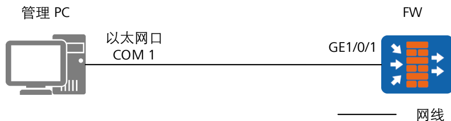
图3-1 防火墙基础配置实验拓扑图
